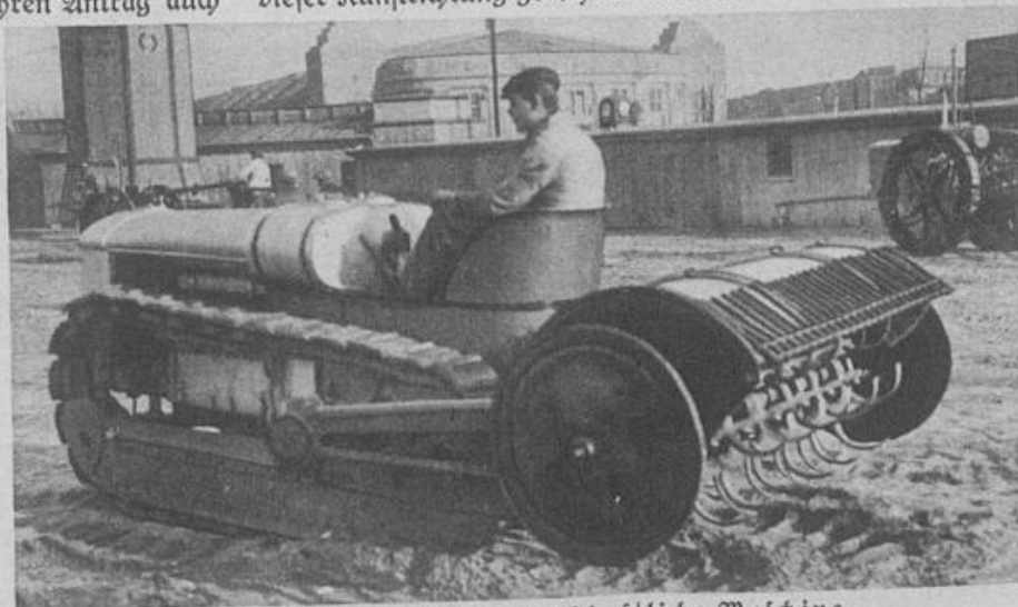
Eine interessante landwirtschaftliche Maschine, die auf der „Grünen Woche“ in Berlin erstmals gezeigt wurde, ist der kombinierte Fräse- und Scharpflug. Die Maschine kann sowohl als Bodenfräse, Motorpflug, sowie auch als Kultivator, Zug- und Antriebsmaschine verwendet werden. [Atlantid]
