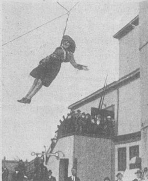
Kein Sprungtuch mehr nötig! Der neuartige Apparat wird bei Feuergefahr mit einem Karabinerhaken an dem Fensterrahmen befestigt und die in Gefahr befindlichen Personen langsam am Seil herabgelassen. [Groß]
