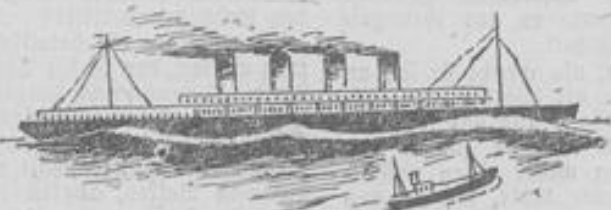
Der große Dampfer liegt gleichzeitig auf mehreren Wellenbergen. Das kleine Schiff jedoch nur auf einer Welle.
