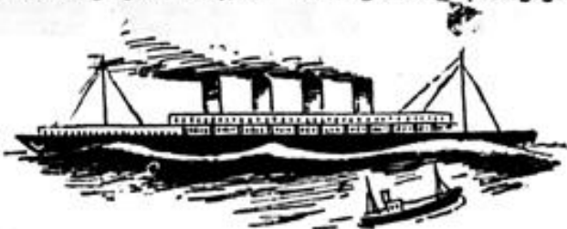
Der große Dampfer liegt gleichzeitig auf mehreren Wellenbergen. Das kleine Schiff jedoch nur auf einer Welle.
