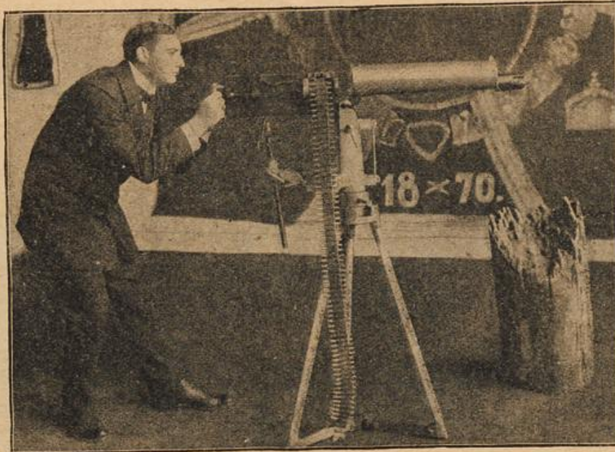
Ein Maschinengewehr, das 600 Schuß in der Minute abfeuert.
