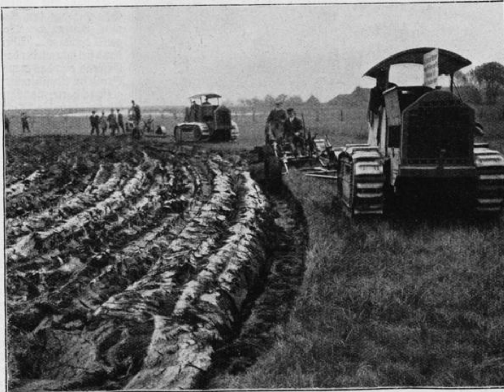
Links: Zwei Hanomagketten Schlepper von je 50 PS bei der Arbeit auf Moorboden. Rechts: Aus dem Boden gezogener Baumstumpf
