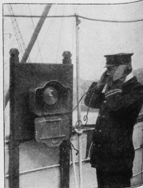
Der Hörapparat auf der Kommandobrücke
