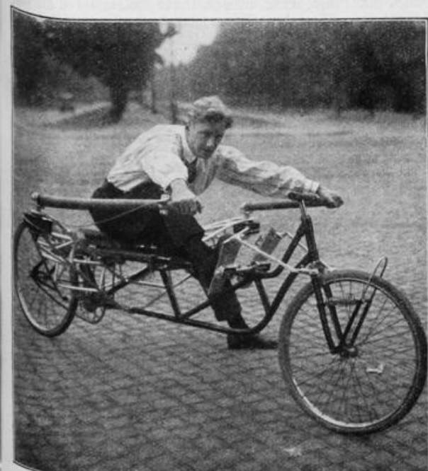
Das Rudomobil, ein neues Sportfahrzeug mit Rollsit, Ruderantrieb und Fußsteuerung. (Atlantif)
