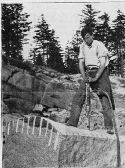
Zerteilen eines Granitblocks mit Preßluftbohrer
