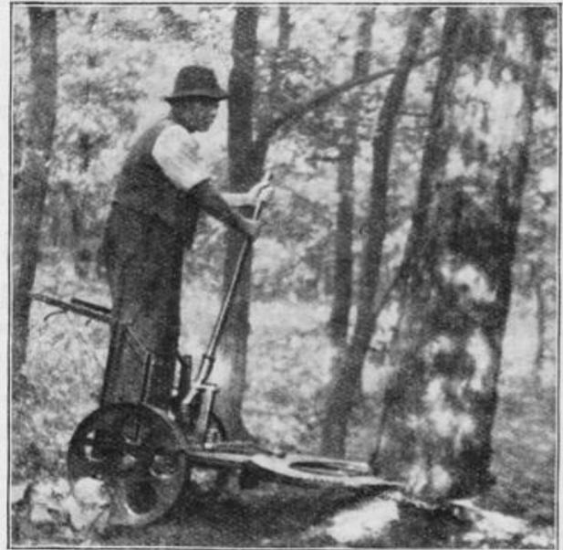
Die Baumfällmaschine in Tätigkeit
