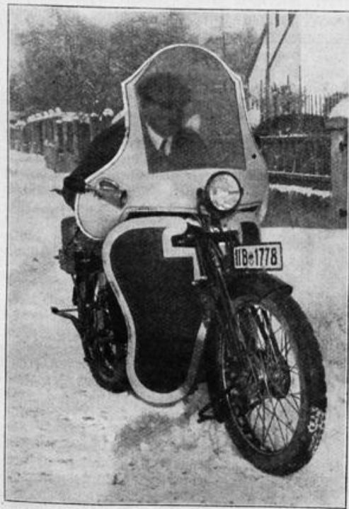
Kälte- und Wetterschutz für Motorräder, eine Vorrichtung aus Blech und Zelluloid, die den ganzen Körper schützt. (Gruber)
