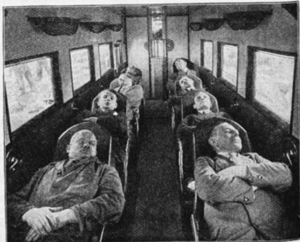
Modernes Großverkehrsflugzeug mit Lehnstühlen, die sich in Schlafgelegenheiten verwandeln lassen, Deckenbeleuchtung und Warmluftheizung
