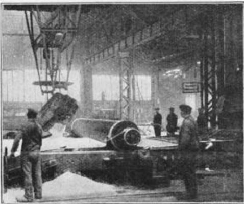
Auswalzen der flüssigen Glasmasse zur Scheibe
