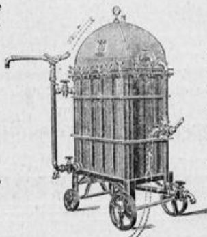
Zum direkten Durchpumpen eingesetzt u. unter Luftabschluss arbeitend.
