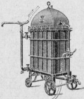
Zum direkten Durchpumpen eingerichtet u. unter Luftabschluss arbeitend.
