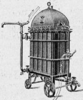
Zum direkten Durchpumpen eingesetzt u. unter Luftabschluss arbeitend.
