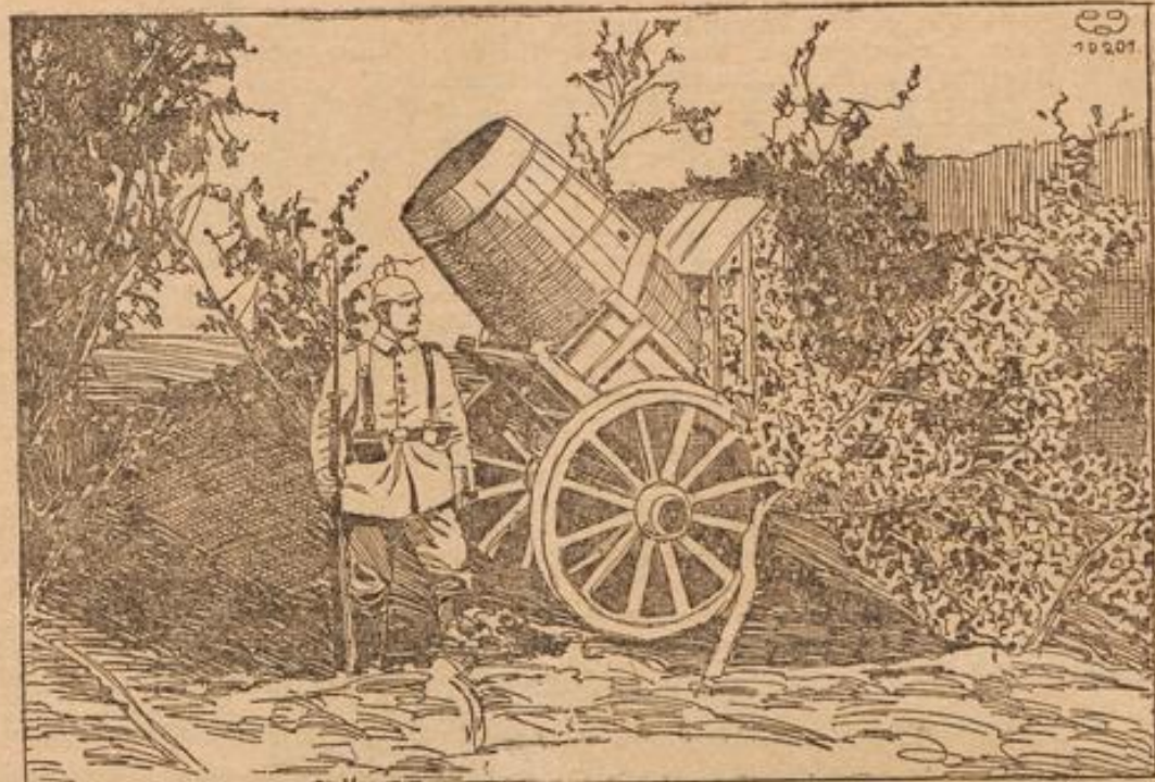
Moderne Kriegskisten: Aus einem Karren und einem Weinfäß konstruierter schwerer Mörser.
