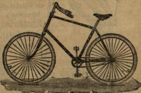
Tourenmaschine 12 1/2 Kg., garant. Tragfähigkeit 125 Kg.
