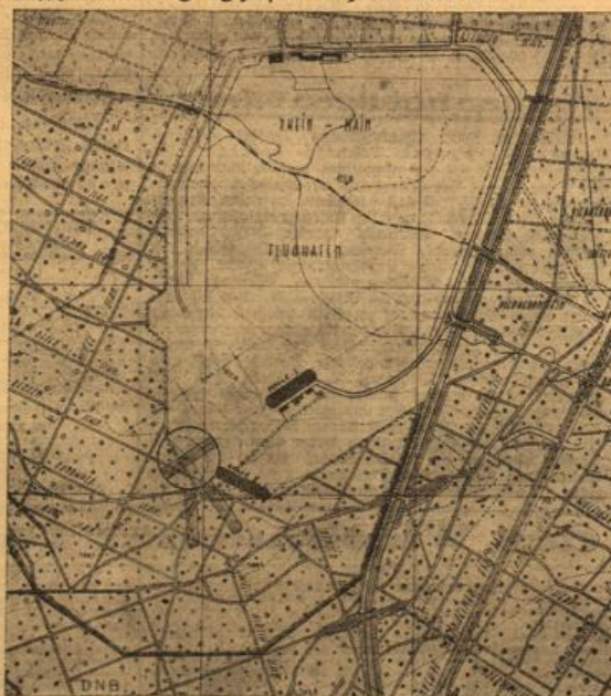
Der Flughafen Rhein-Main in seiner früheren Größe (obere weiße Fläche). Die gestrichelte Linie: Grenze des erweiterten Flugplatzes 1938. Fast quer zur Halle I entsteht Halle II, dahinter Raum für zwei weitere Hallen. Im Kreis eine geplante dreifache Luftschiffhalle.
