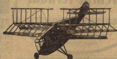
Ein Modell der neuen Rohrbach'schen Konstruktion, des Umlaufstiftungs-Flugzeugs.
