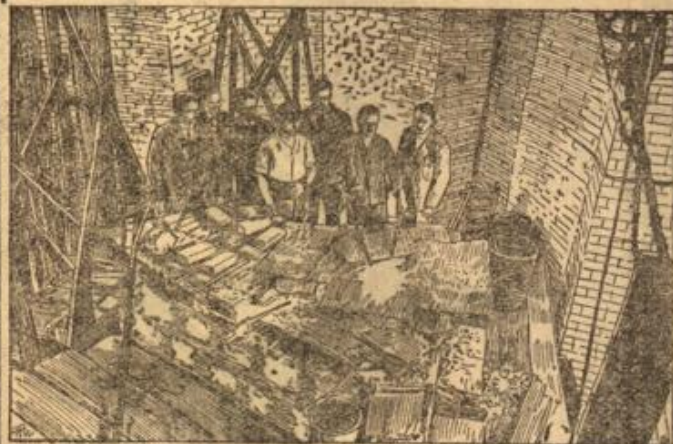
Glockenguß im Berliner Dom. Ein Riß in der großen Glocke des Berliner Doms wird durch ein neuartiges Verfahren geschweisht.
