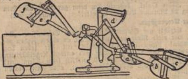
Schematische Darstellung der Arbeitsweise des Schaufelladers.
