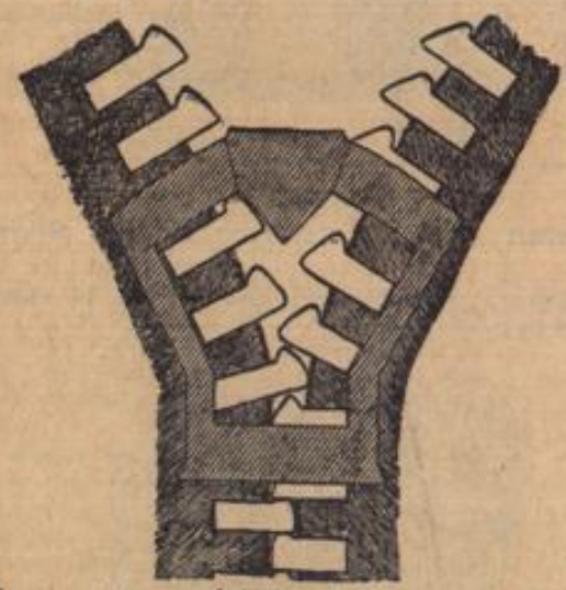
So trennt oder vereint der Schieber die Zähne des Reißverschlusses.
