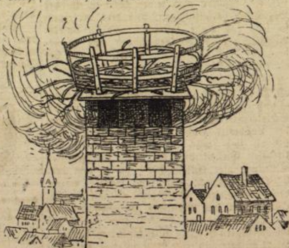
Korbgerüst aus Eisen als Unterlage für ein Storchnest.
