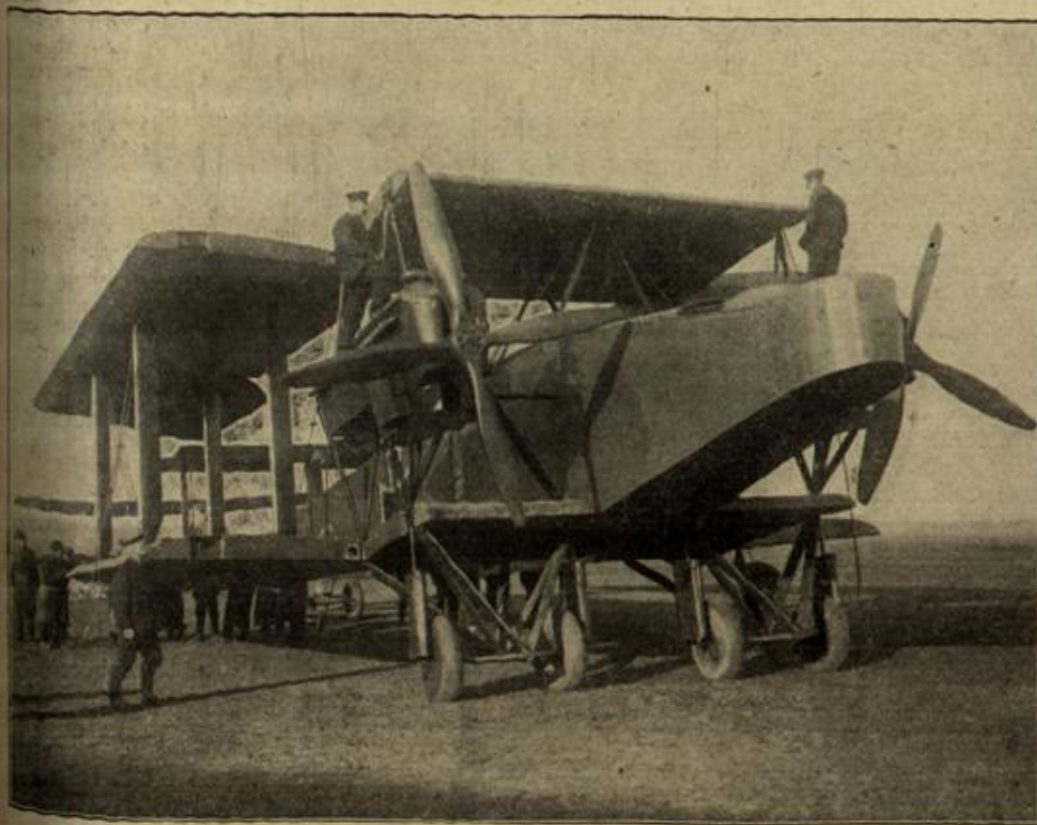
Vom Kampf in den Lüften: Erbeutetes englisches Großflugzeug (Typ Handley-Page), das unverfehrt in deutsche Hände fiel. Das Flugzeug ist 30 m breit, 20 m lang und 6 1/2 m hoch, hat 2 Motore zu je 260 P. S., die zwei vierflüglige Pro- peller treiben. Bewaffnung: 3 Maschinengewehre; Besatzung: 5 Mann.
