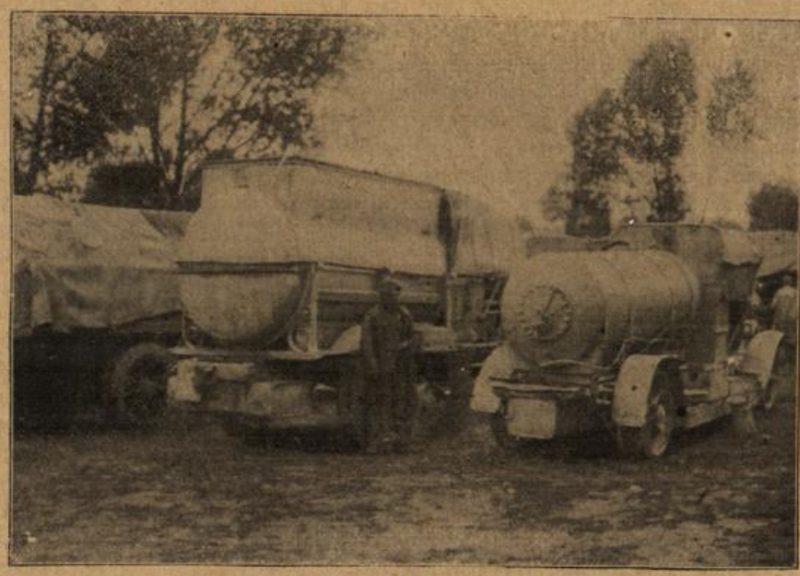
Benzenwagen des österreichischen Heeres. Der größere Wagen faßt 5000 Kilo, der kleinere 2000 Kilo Benzin.
