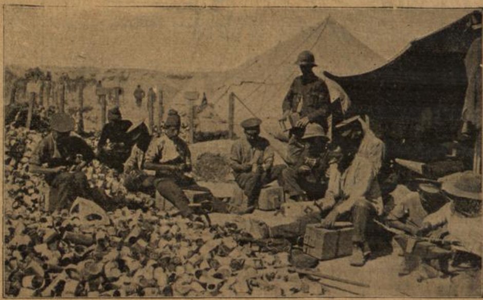
Herstellung von Kriegsmaterial durch englische Truppen auf Gallipoli Die Anfertigung von Bomben, wobei alte Konservendbüchsen verwendet werden.
