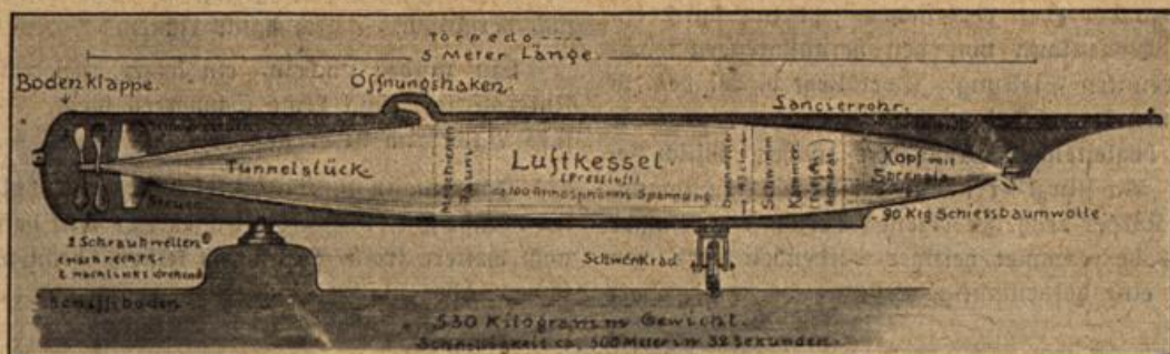
Schematische Darstellung eines Torpedos im Lancierrohr
