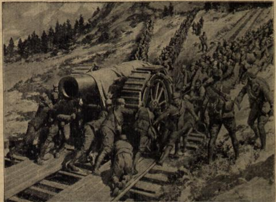
Transport eines schweren italienischen Mörsers auf einem eigens zu diesem Zwecke angelegten Geleise.
