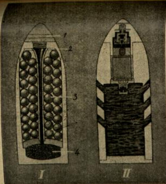
Querschnitt I. Schrapnell, ein dünnwandiges Geschöß mit Kugelfüllung, das in der Luft zerplatzt: 1. Zünder, 2. Geschößwand, 3. Kugelfüllung, 4. Pulverladung.
