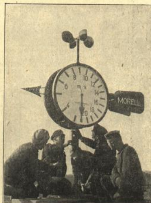
Ein Böenmesser zur Ermittlung der Windgeschwindigkeit.
