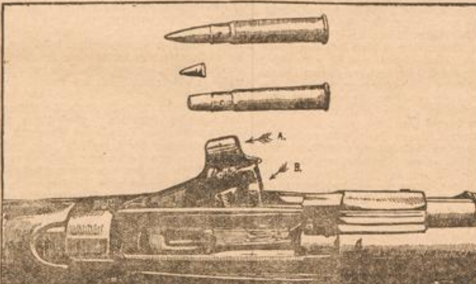
Englisches Gewehr mit Dum-dum-Herstellungsvorrichtung. Die Patronenspitze wird in der Hülse a abgeknickt und der Bruchrand durch Eindrücken in b geglättet, damit der Lauf nicht zerkratzt wird.
